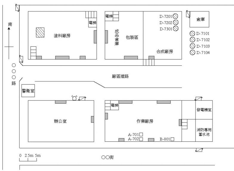
圖例：■ 緊急出口 □□ 安全梯 ▲ 室外消防栓 □ 連接送水管送水口
