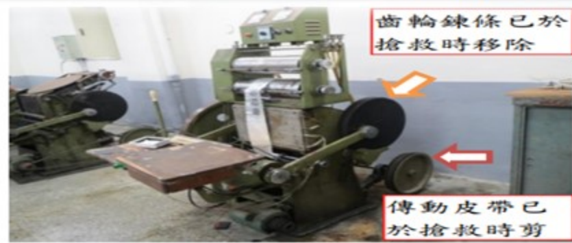
圖 1.發生災害之燙金機 (傳動皮帶已被剪斷、齒輪鍊條已移除)
